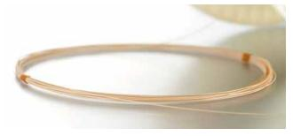
PEEK 编织纤维: 我们的 PEEK 编织纤维具有隔热性,可以防止粗暴搬运和部件部署造成的磨损。这种高度耐用的材料具有优异的机械强度和刚度,可在高达 260 °C / 500 °F 的温度下使用。PEEK的耐水解性高,具有广泛的耐化学腐蚀性,适用于几乎任何能源环境。我们提供多种颜色的 PEEK纤维,其尺寸和剖面形状均可定制。
